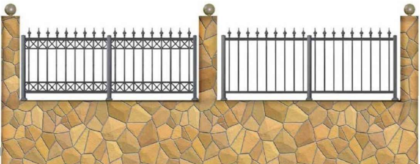
Ύψος αυλόγυρου έως 95 cm / Fence railing height 95 cm
